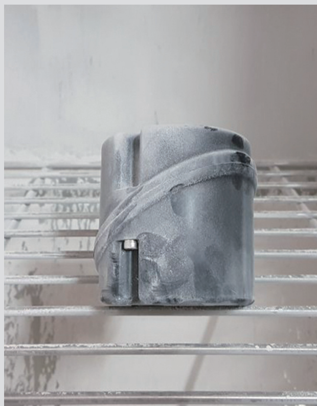
Carcasa durante la prueba IP6x
