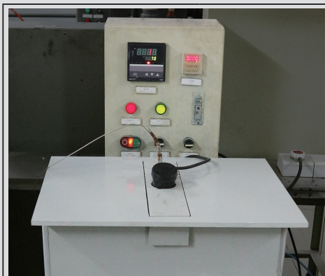
Baño de prueba con hipoclorito de sodio
