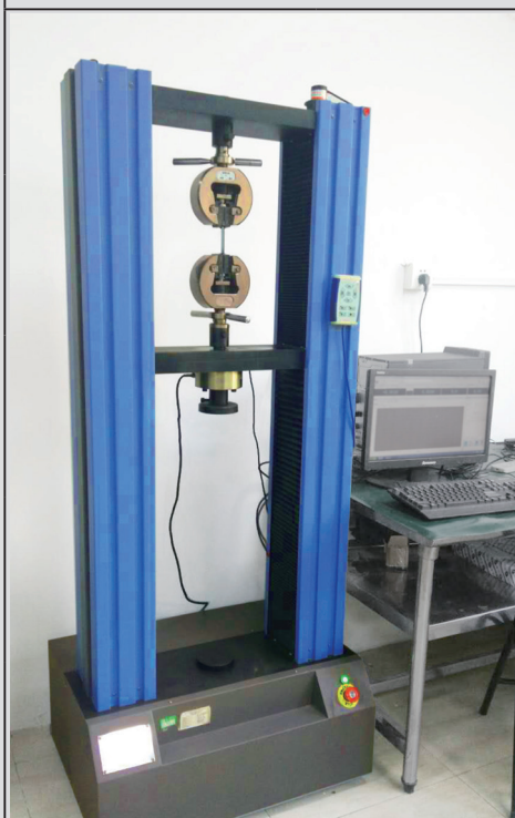
Equipo de medición de resistencia a la tracción en la rotura
