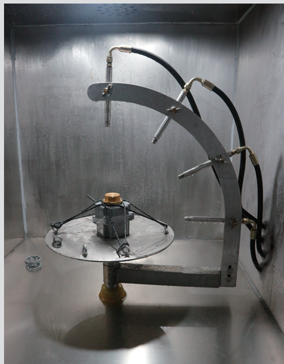
Carcasa durante la prueba IPx9k
