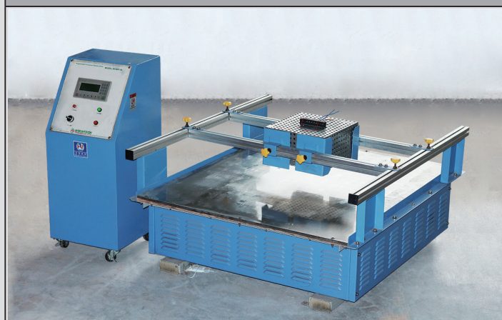
Equipo de prueba de vibración
